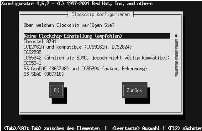
Abbildung 5-14. Dialogfeld zum Konfigurieren des Clockchip
